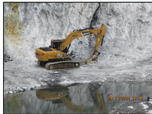
ภาพที่ 2.16 การใช้เครื่องจักร Hydraulic Breaker มาใช้ในการทำเหมือง
