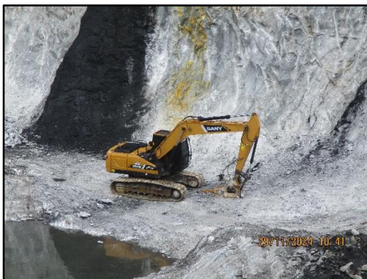
ภาพที่ 2.16 การใช้เครื่องจักร Hydraulic Breaker มาใช้ในการทำเหมือง
